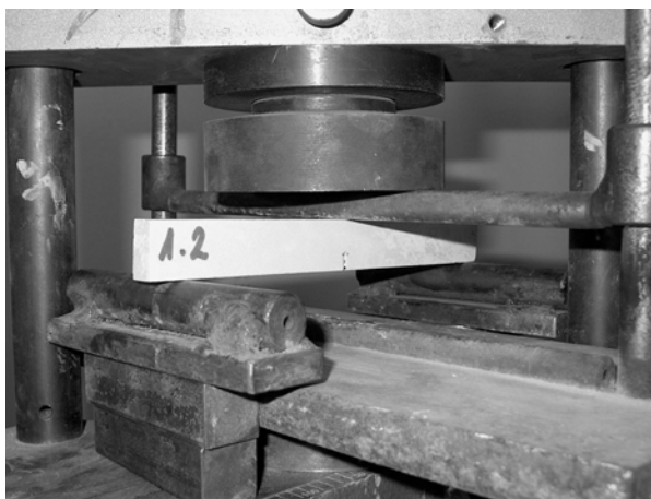
Фиг. 7. Изпитване на скален образец чрез натоварване на огъване в хидравлична преса.
